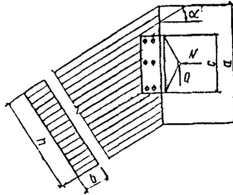
Рис. 18. Конструктивная схема ключевого шарнира арки (к определению коэффициента  $K_N$ )
