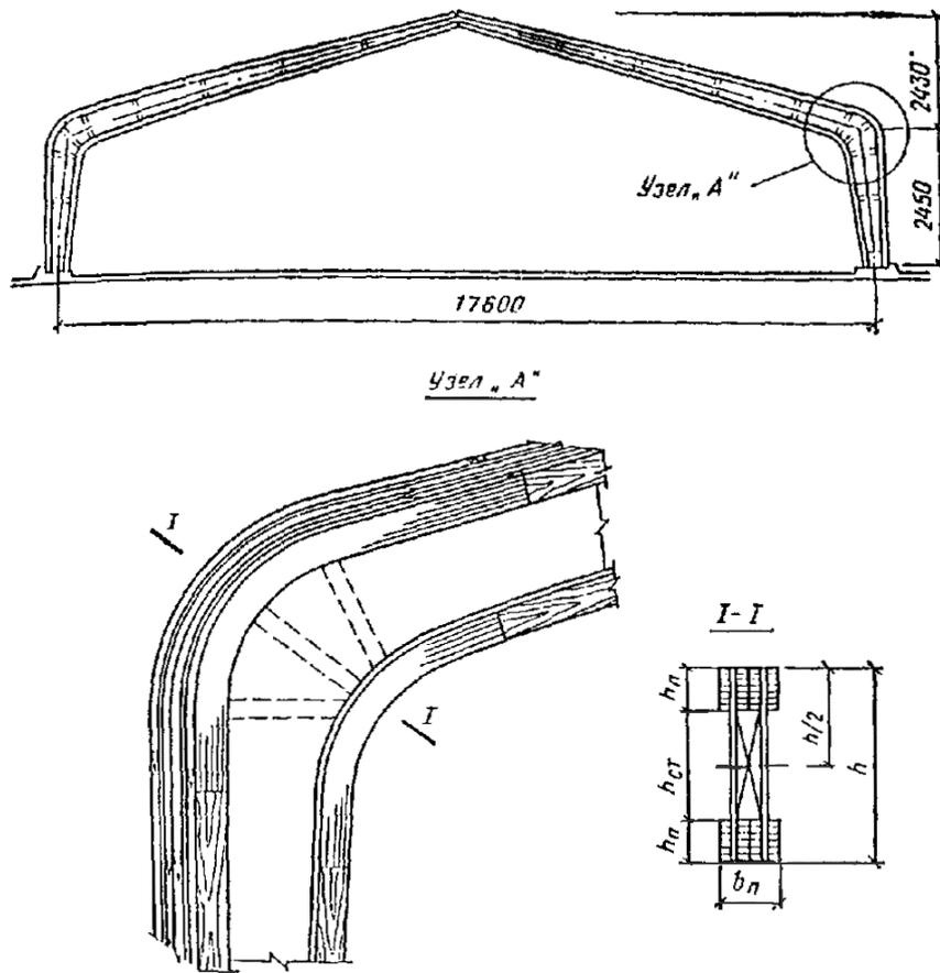
Рис. 53. Клефанерная трехшарнирная рама с гнотоклееными вставками в карнизных узлах
