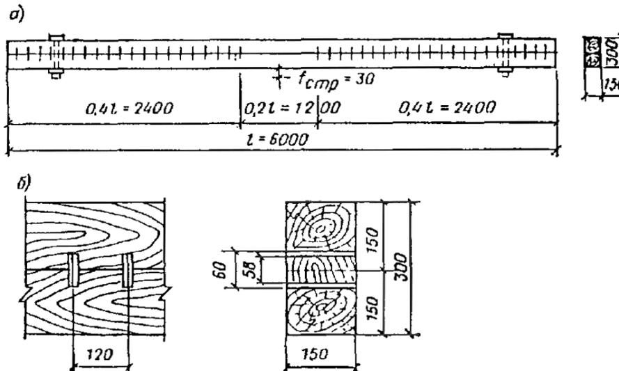
Рис. 33. Составная брусовая балка на пластинчатых нагелях
