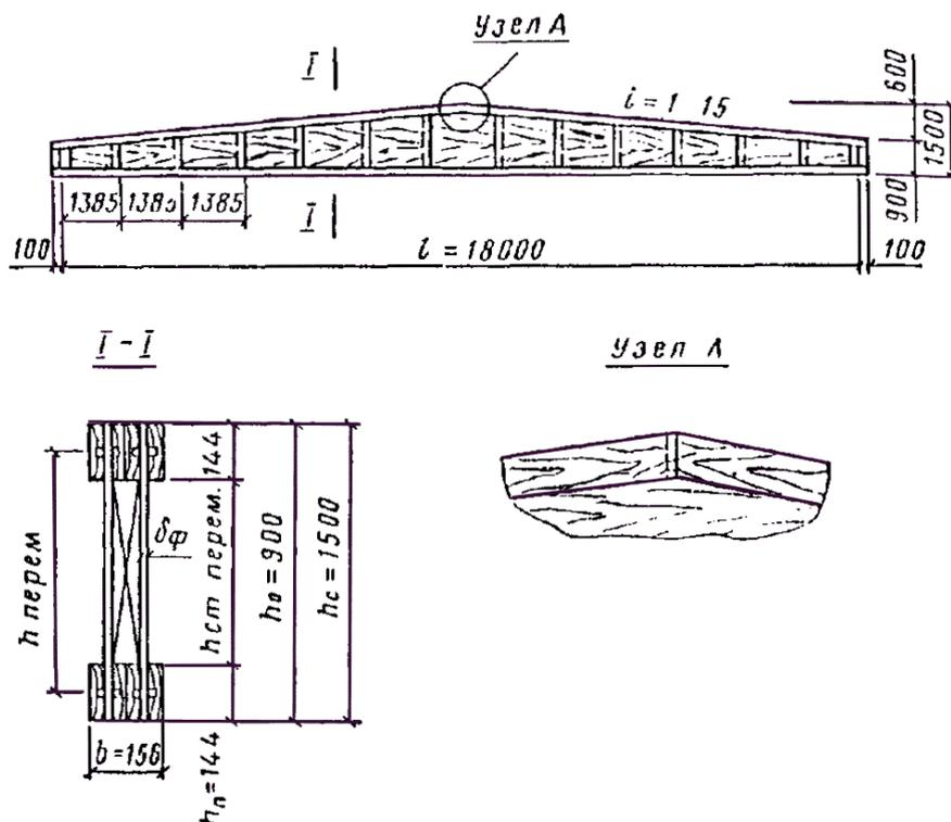
Рис. 32. Двускатная клефанерная балка покрытия
