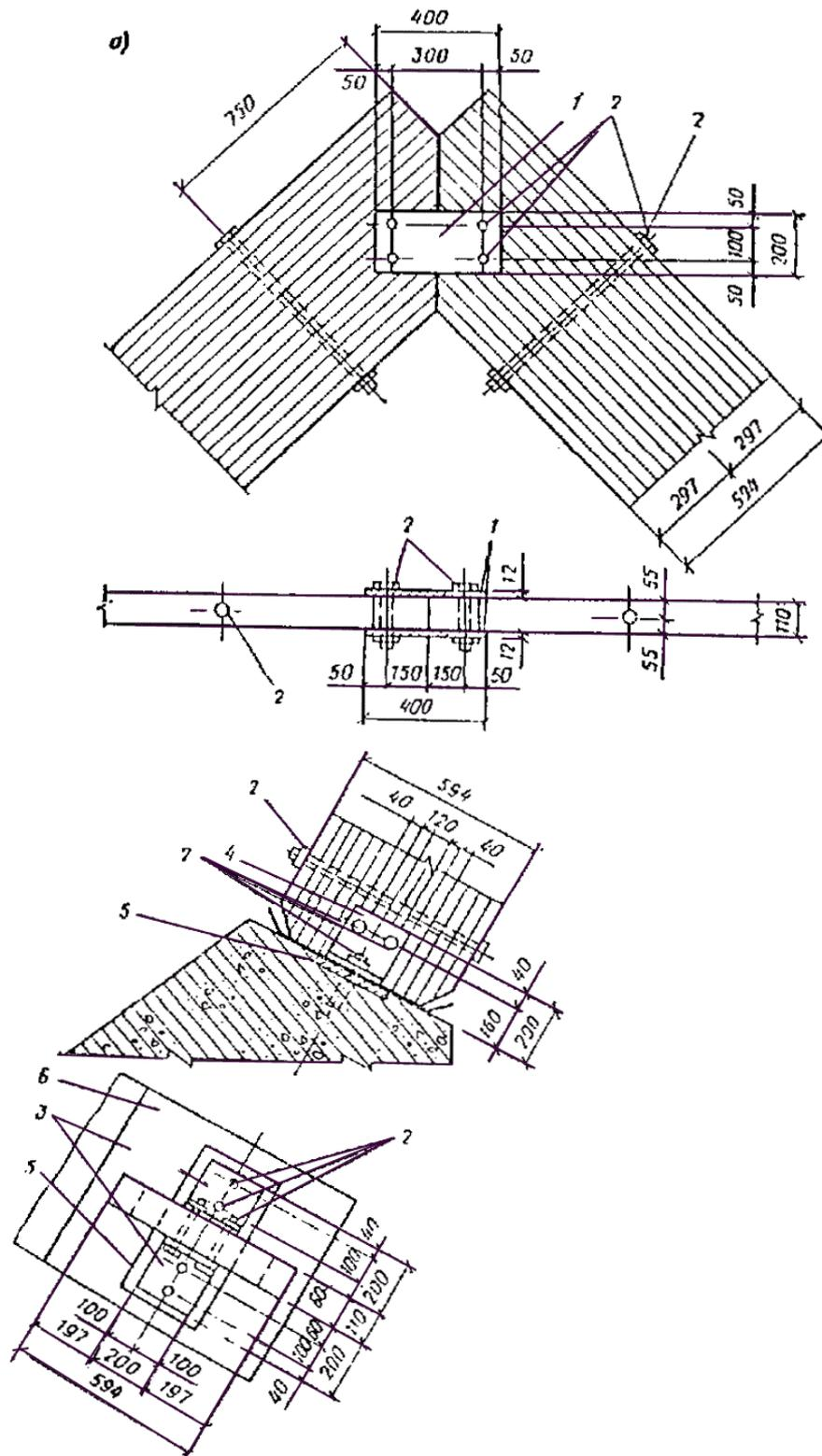
**Рис. 51. Коньковый (а) и опорный (б) узлы стрельчатой арки**
