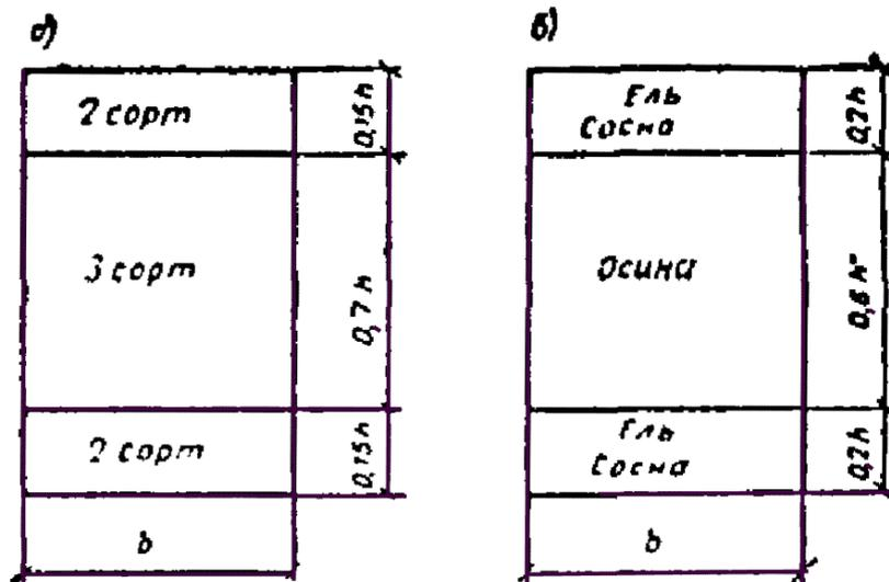
Рис. 25. Примеры компоновки сечения дощатых клееных балок
