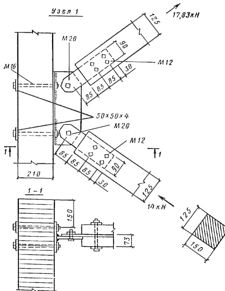
Рис. 68. Узел крепления раскосов решетки связевой фермы к балке
