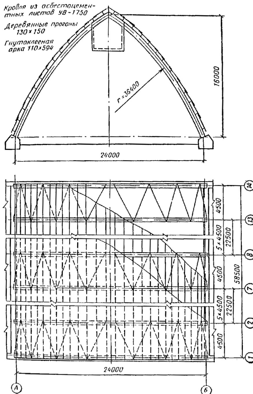
Рис. 48. Поперечный разрез и план здания склада
