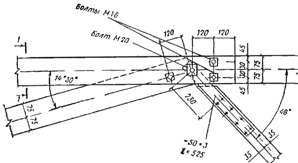
Рис. 38. Узел «Б» брусчатой фермы
