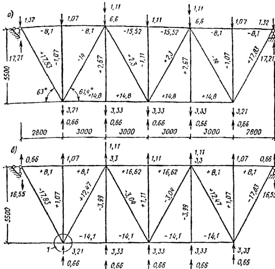
Рис. 67. Схема нагружения левой связевой фермы (см. рис. 65) и расчетные усилия в ее элементах
