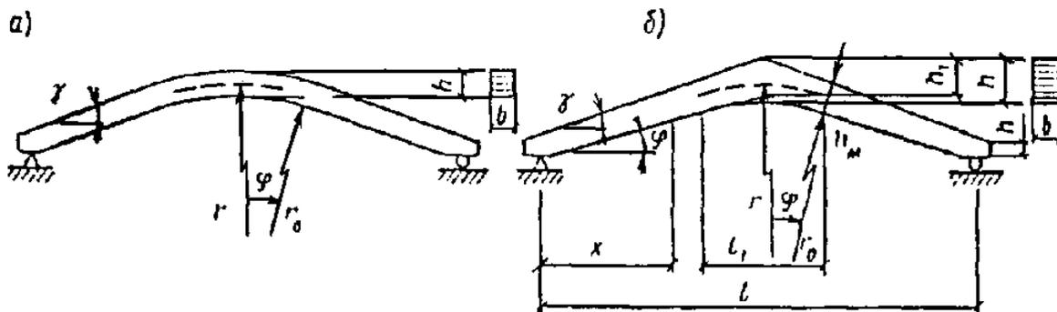
Рис. 27. Гнутоклееные балки
