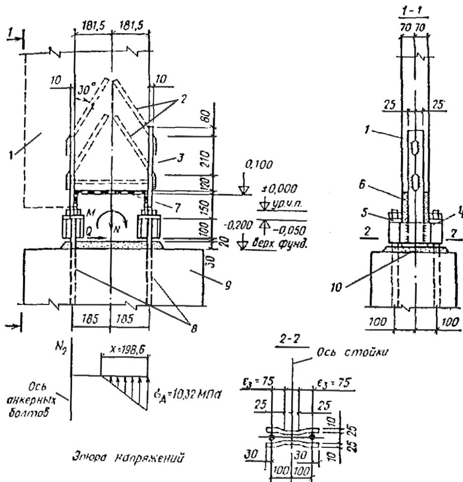
Рис. 58. Опорный узел рамы
