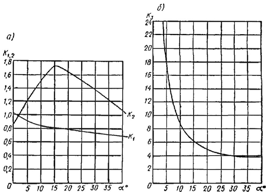
Рис. 13. Графики зависимости коэффициентов  $K_1$ ,  $K_2$ ,  $K_3$  от угла наклона волокон для зубчатого соединения по всему сечению
