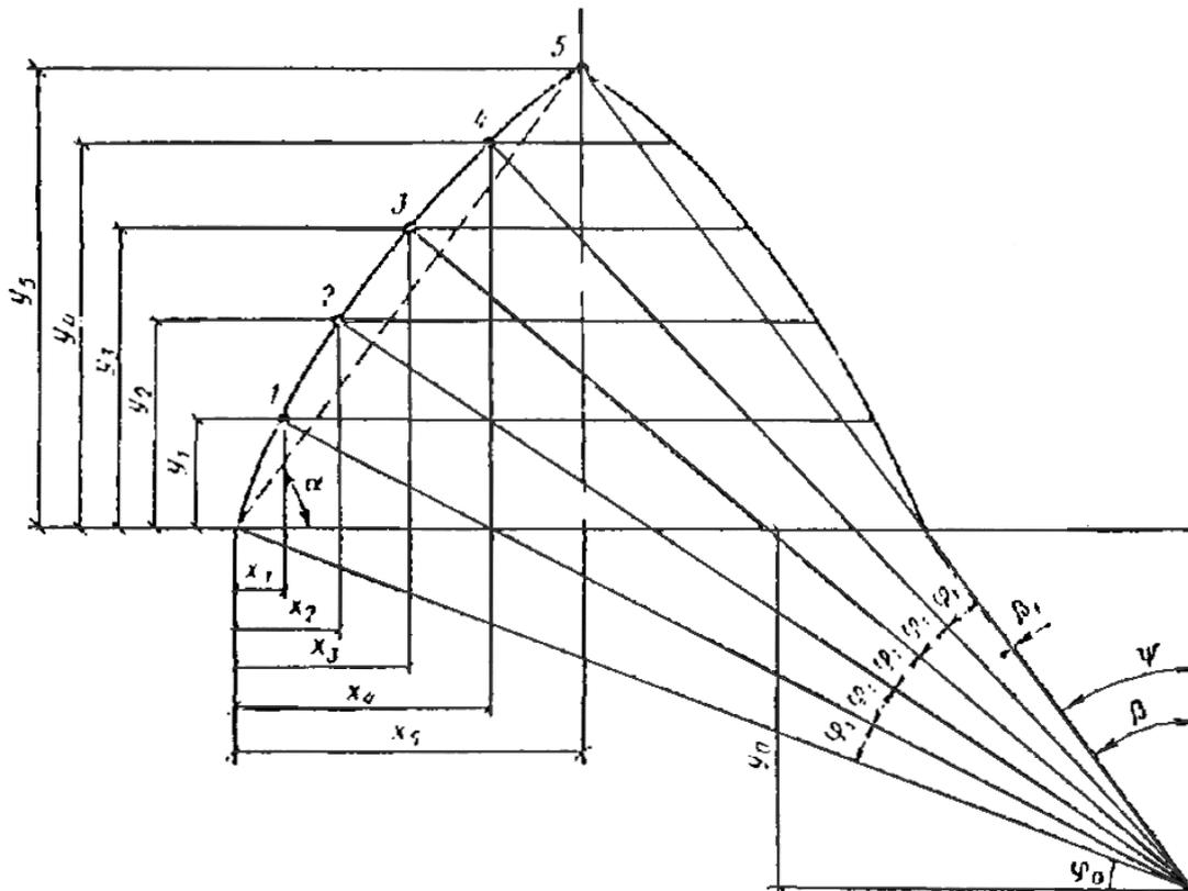
**Рис. 49. Построение геометрической оси арки**
