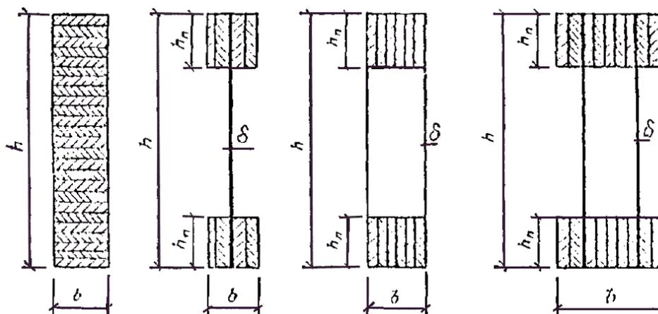
Рис. 3. Примеры компоновки поперечного сечения элементов из клееной древесины
