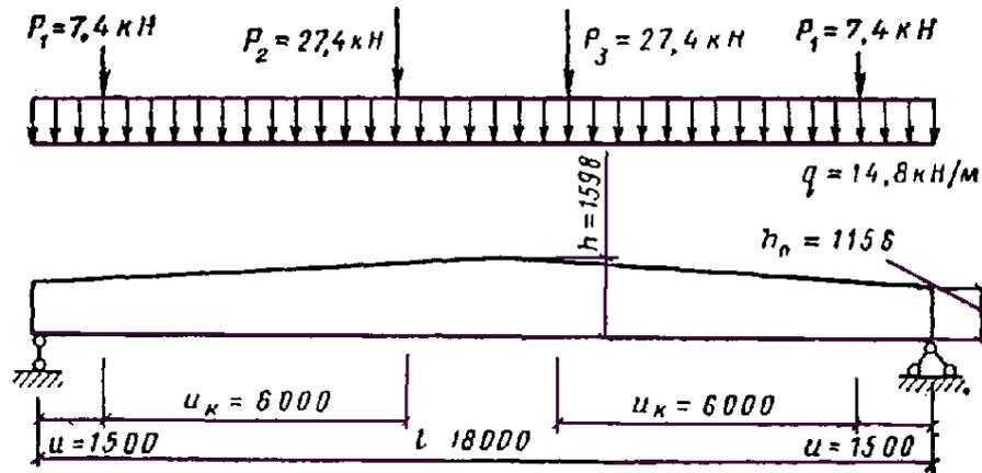
Рис. 31. Расчетная схема дощатоклеенной балки покрытия с подвесным оборудованием
