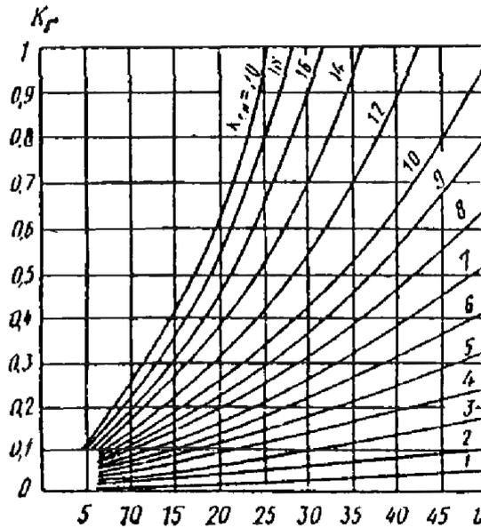
**Рис. 71. График значений грузовых коэффициентов  $K_G$  в зависимости от коэффициента собственного веса  $K_{CB}$  и пролета конструкции  $l$ , м.**
