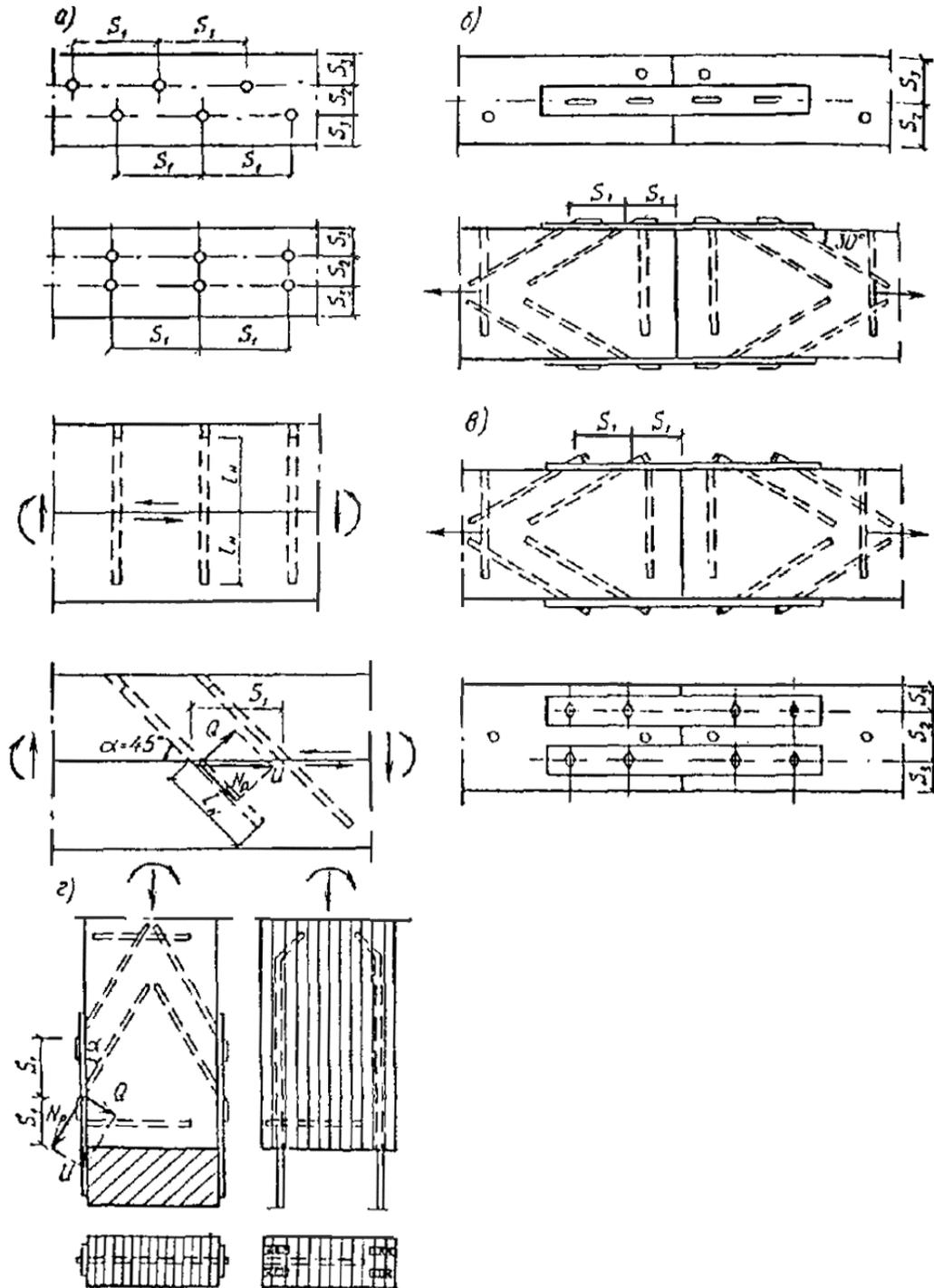
**Рис. 16.** Соединения на вклеенных в древесину стержнях из арматурной стали
