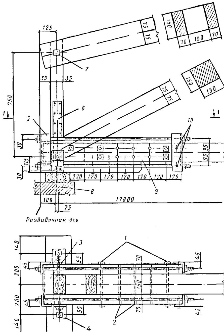
Рис. 37. Конструкции опорного узла «А» брусчатой фермы
