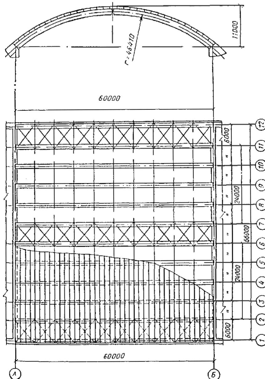
**Рис. 42. Поперечный разрез и план арочного покрытия**
