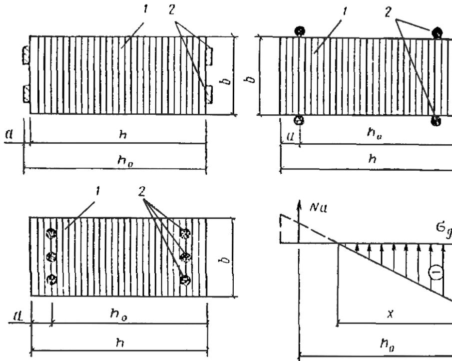
**Рис. 62.** Варианты анкеровки клееной колонны в подошве посредством металлических деталей
