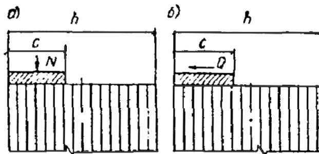
Рис. 20. Схема загрузки торца деревянного элемента местной нагрузкой
