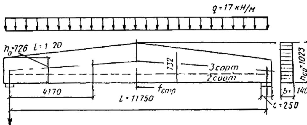
**Рис. 30.** Двускатная дощатоклеенная балка покрытия
