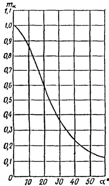
Рис. 14. График зависимости коэффициента  $m_\alpha$  от угла наклона волокон (к определению расчетного сопротивления изгиба  $R_{II}$  при проверке прочности внешне растянутой кромки узлового соединения на зубчатый шип)
