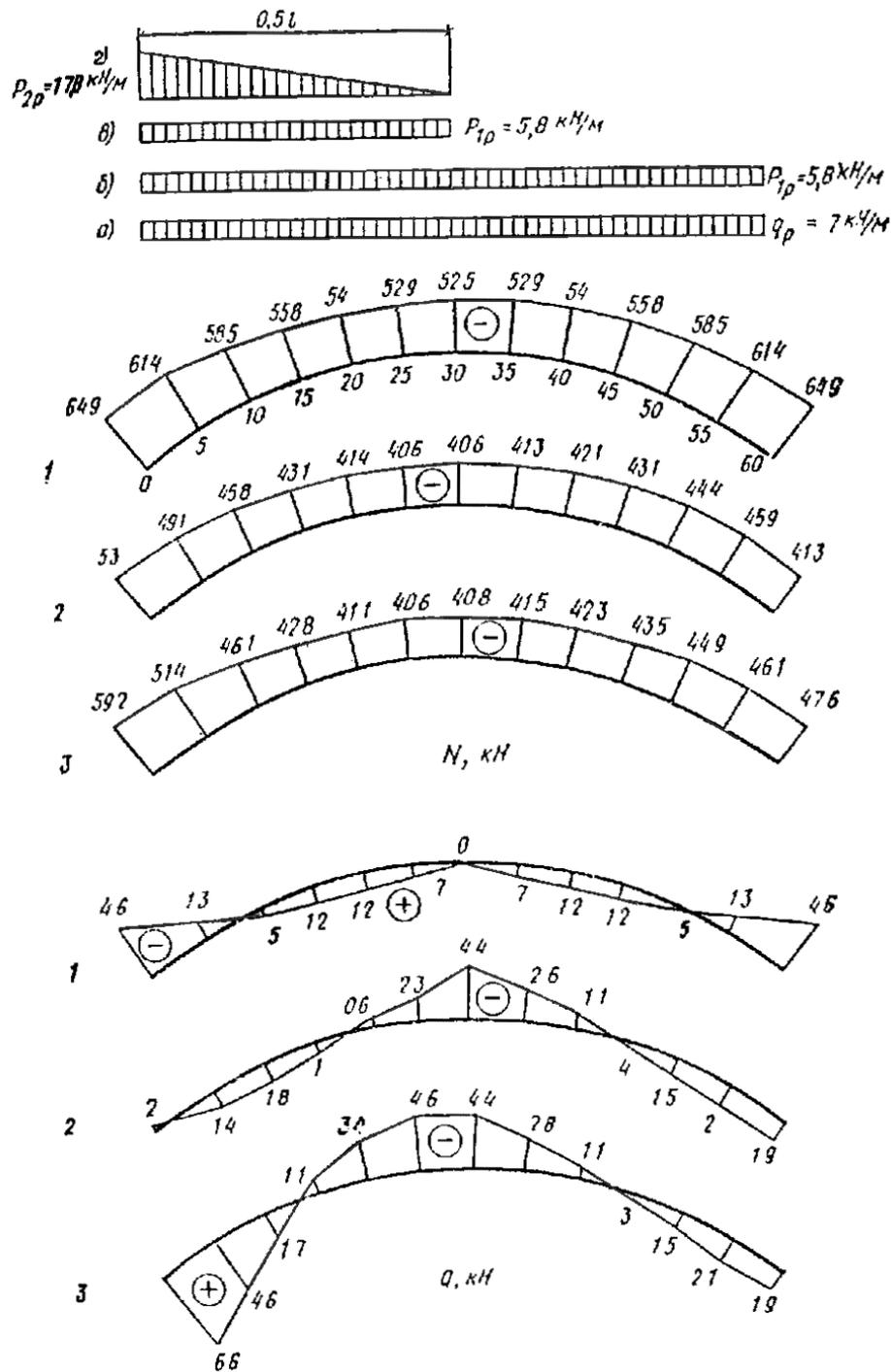
Рис. 45. Эпюры нормальных ( $N$ ) и поперечных ( $Q$ ) сил в арке от сочетания расчетных нагрузок
