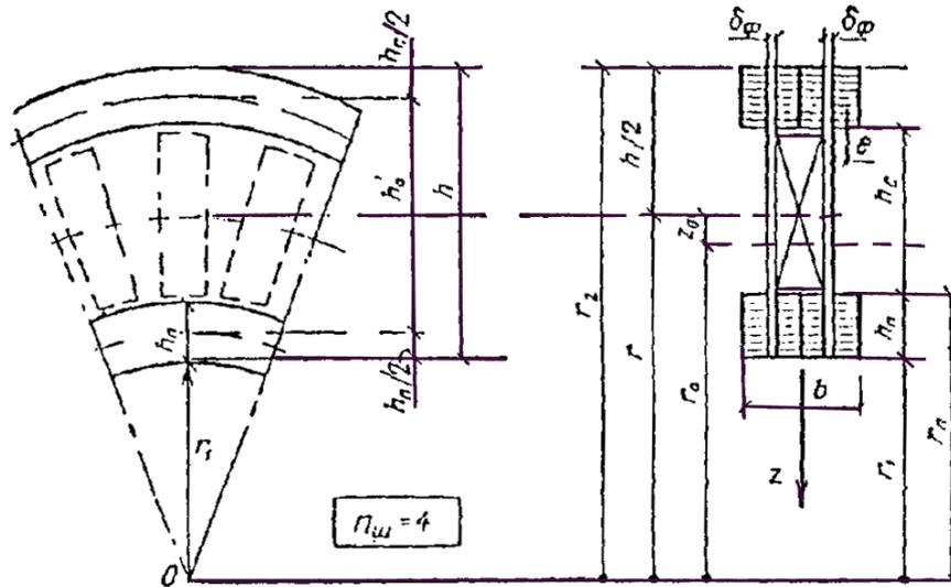
Рис. 9. Геометрические характеристики гнутоклееного элемента с фанерными стенками
