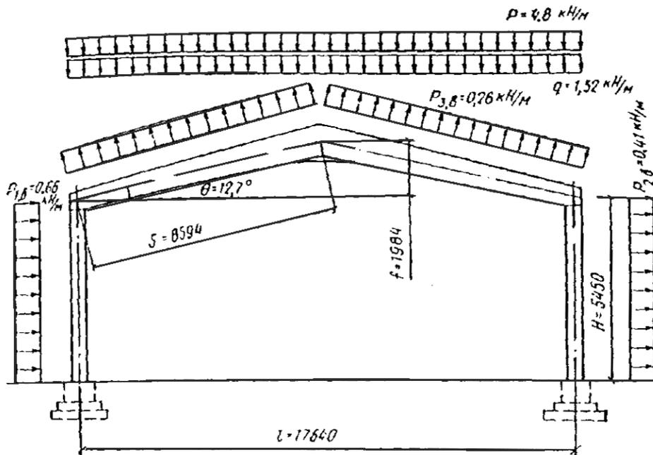
Рис. 54. Схема рамы с нагрузками
