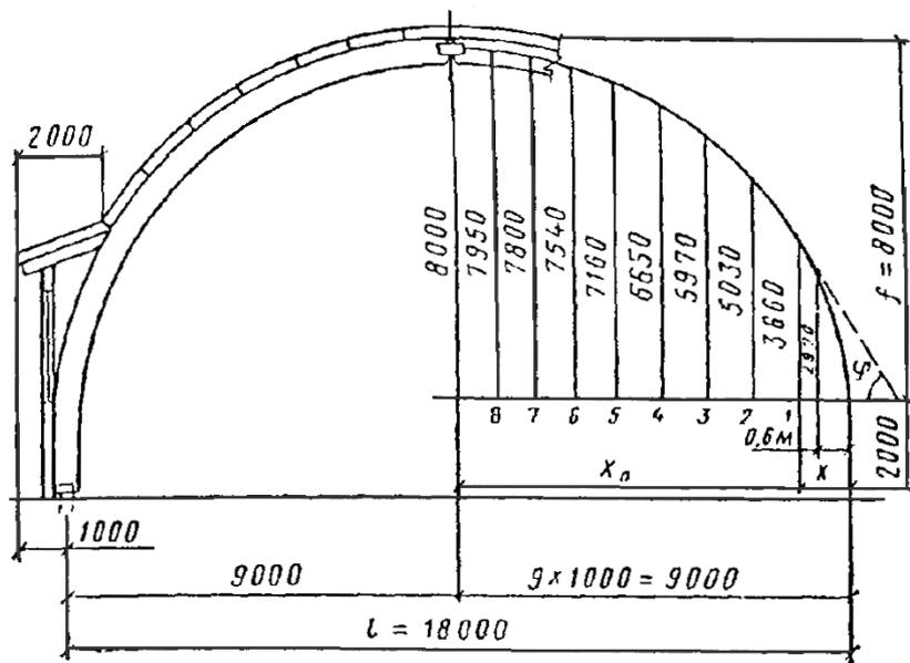
Рис. 59. Схема поперечного разреза здания
