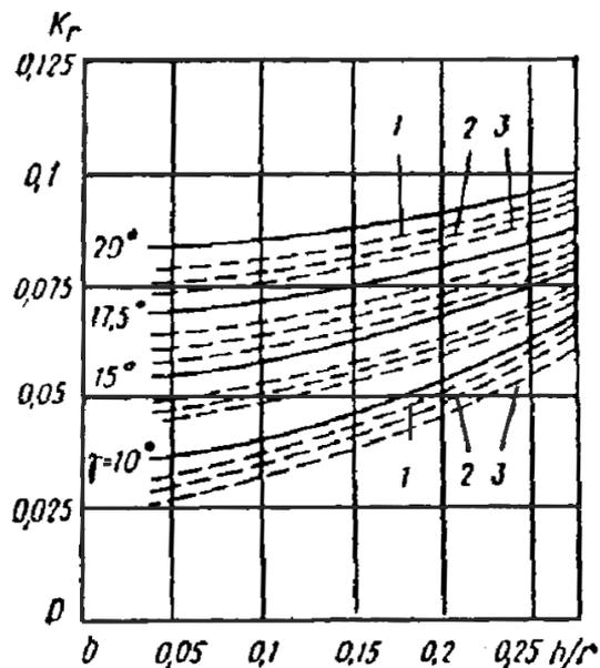
**Рис. 28.** График для определения коэффициента  $K$  при расчете гнутоклееных балок переменной высоты
