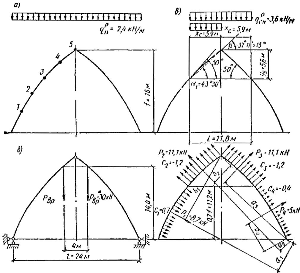
Рис. 50. Схема нагрузок, действующих на арку
