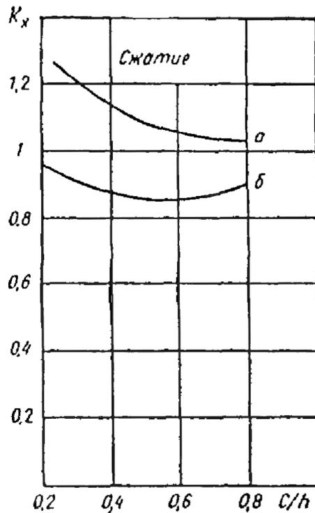
Рис. 21. График для определения коэффициента концентрации напряжений вдоль волокон  $K_x$
