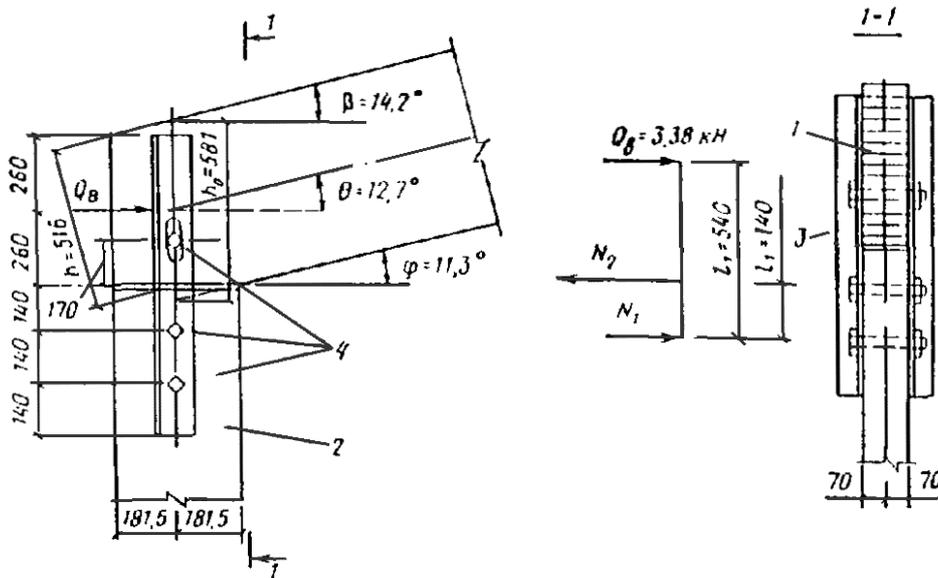
**Рис. 57. Карнизный узел рамы**
