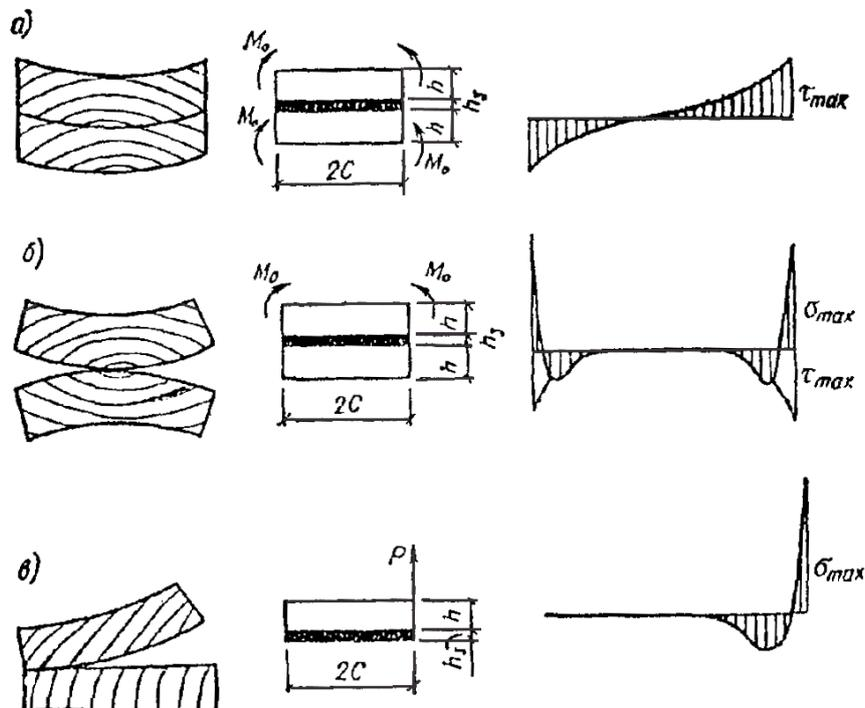
Рис. 15. Характер распределения собственных внутренних нормальных и касательных напряжений поперек волокон, возникающих при высыхании клееной древесины в случае трех типичных сочетаний досок с различным расположением годовых слоев в сечении
