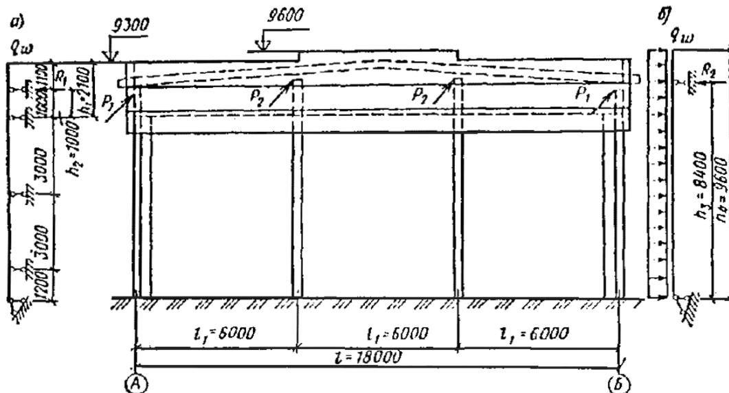
Рис. 66. Схема торцевой стены здания. Расчетные схемы стоек фахверка
