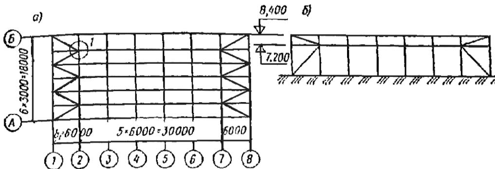
**Рис. 65. Схема продольных и поперечных связей жесткости**
