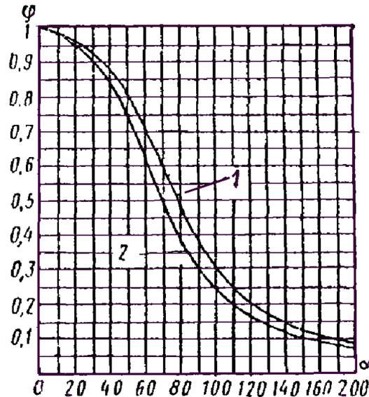
Рис. 70. График определения коэффициента продольного изгиба  $\varphi$  по формулам (7) и (8) [СНиП II-25-80](#)
