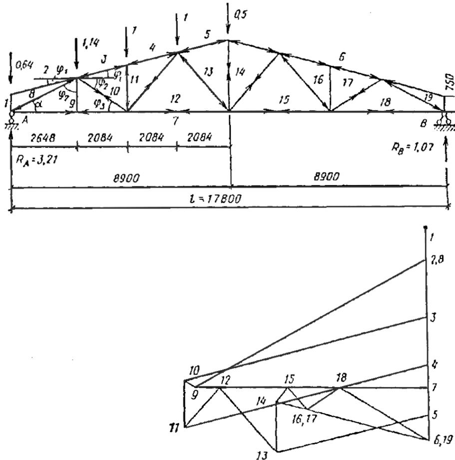
Рис. 35. Расчетная схема нагружения фермы и диаграмма усилий в ее элементах
