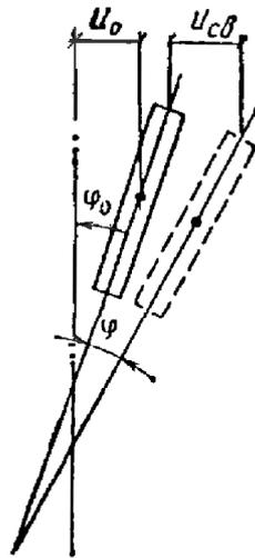
**Рис. 64.** Перемещения поворота и погиби дощатоклееной балки покрытия из ее плоскости в середине пролета, выполняющей функции пояса поперечной связевой фермы
