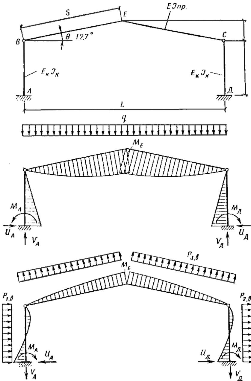
Рис. 56. Расчетная схема рамы и эпюры изгибающих моментов
