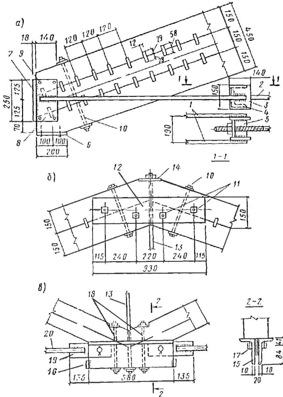
**Рис. 41. Узлы металлодеревянной треугольной фермы**
