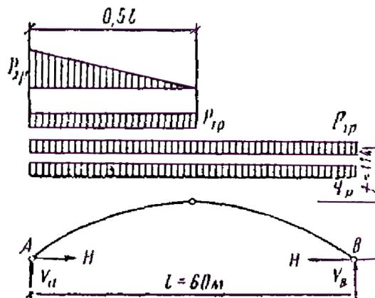
**Рис. 43. Схема нагрузок от собственного веса и снега, действующих на арку**
