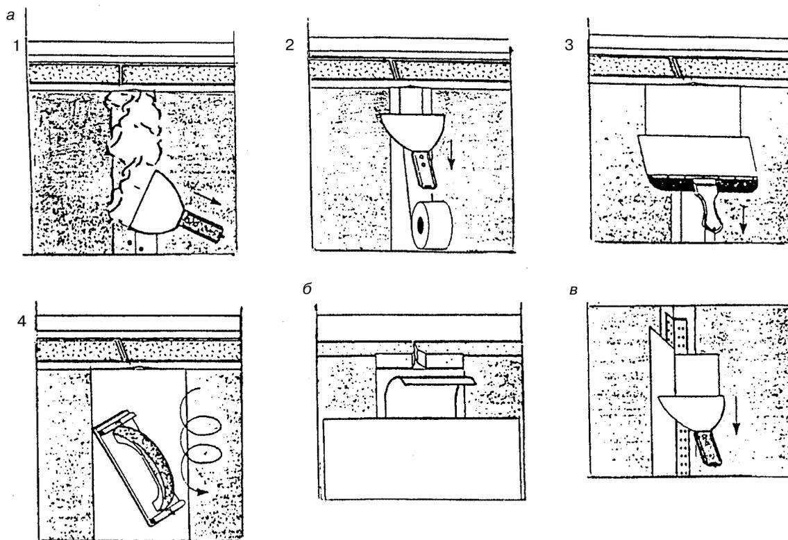
1 — нанесение шпаклевки; 2 — укладка армирующей ленты; 3 — нанесение накрывочного выравнивающего слоя в шпаклевке; 4 — шлифовка шва
