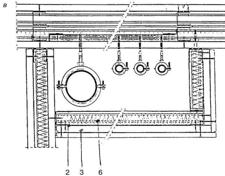
1 — дюбель; 2 — металлический профиль; 3 — обшивка из ГКЛ; 4 — уплотнительная лента или герметик; 5 — самонарезающий шуруп; 6 — минераловатная плита
