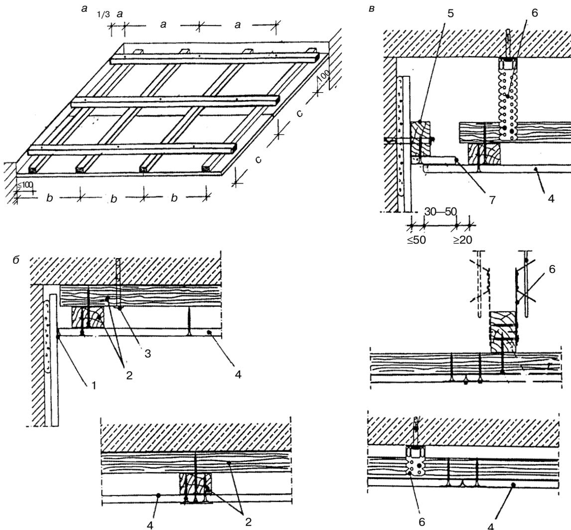
1 — разделительная лента; 2 — бруски каркаса; 3 — анкерный элемент; 4 — обшивка из ГКЛ;
