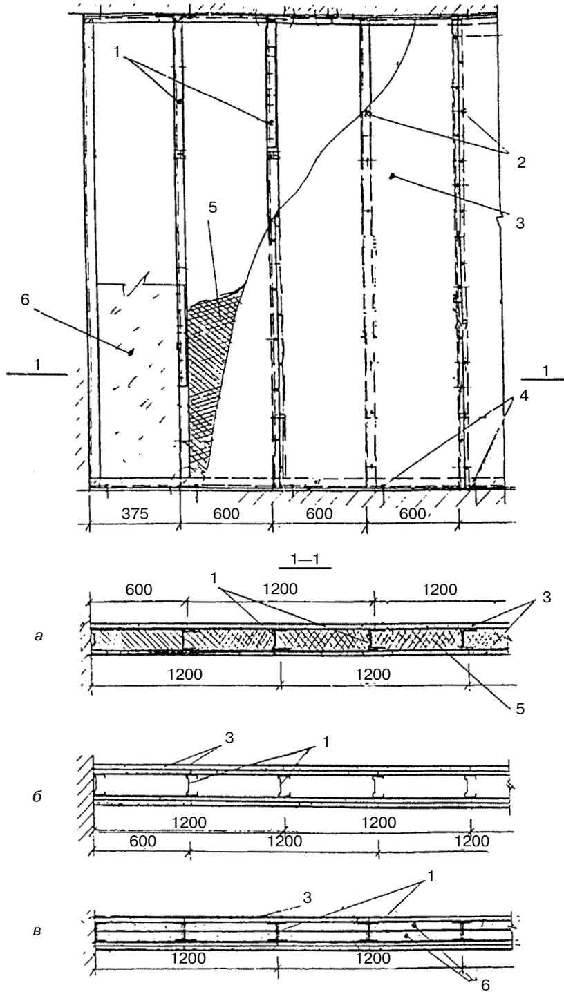
1 — каркас; 2 — шурупы; 3 — обшивка из гипсокартонных листов; 4 — дюбели; 5 — звукоизоляционный материал;
