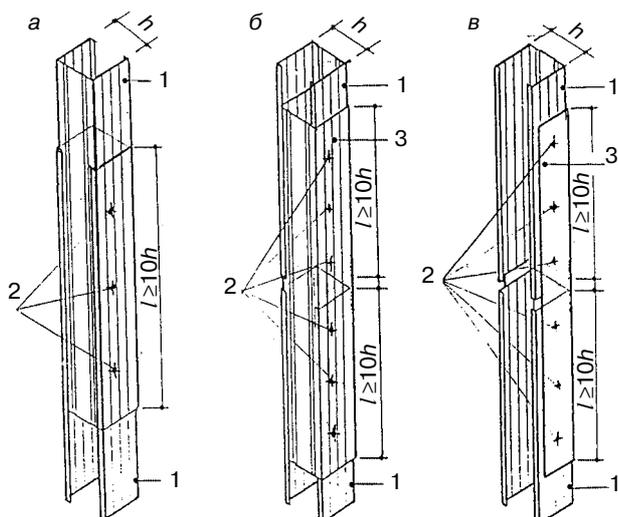
1 — стыкуемые профили; 2 — шурупы; 3 — дополнительный профиль
