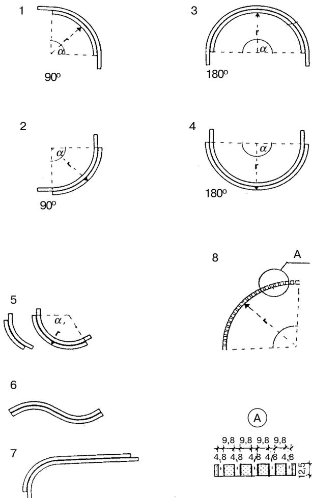
1, 2 — с углом  $90^\circ$ ; 3, 4 — с углом  $180^\circ$ ; 5 — с любым углом до  $180^\circ$ ; 6 — S-образный; 7 — изогнутый по длине; 8 — криволинейный элемент со шлицевыми пазами
