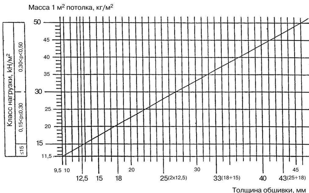
**Рисунок 31** — График для определения класса нагрузки подвесного потолка. График приведен без учета дополнительных нагрузок (светильники, изоляционный слой и т. п.). С учетом дополнительных нагрузок прямая графика смещается вверх на величину, равную дополнительной нагрузке.
