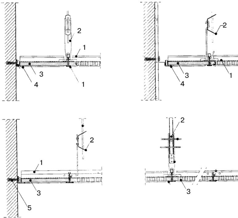
1 — металлические профили каркаса; 2 — подвес; 3 — потолочный элемент из ГКЛ; 4 — обрамляющий профиль; 5 — дюбель; *a* — расстояние между подвесами; *b* — расстояние между несущими профилями; *c* — расстояние между основными профилями
