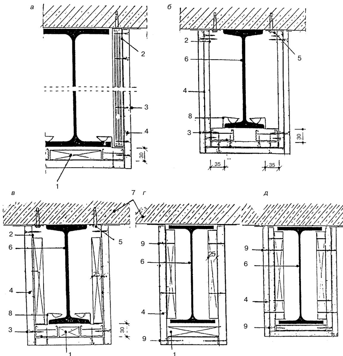
1 — вкладыш; 2 — металлический профиль; 3 — самонарезающий шуруп; 4 — обшивка из ГКЛО; 5 — анкерный элемент; 6 — стальной ригель; 7 — перекрытие; 8 — зажим; 9 — скоба
