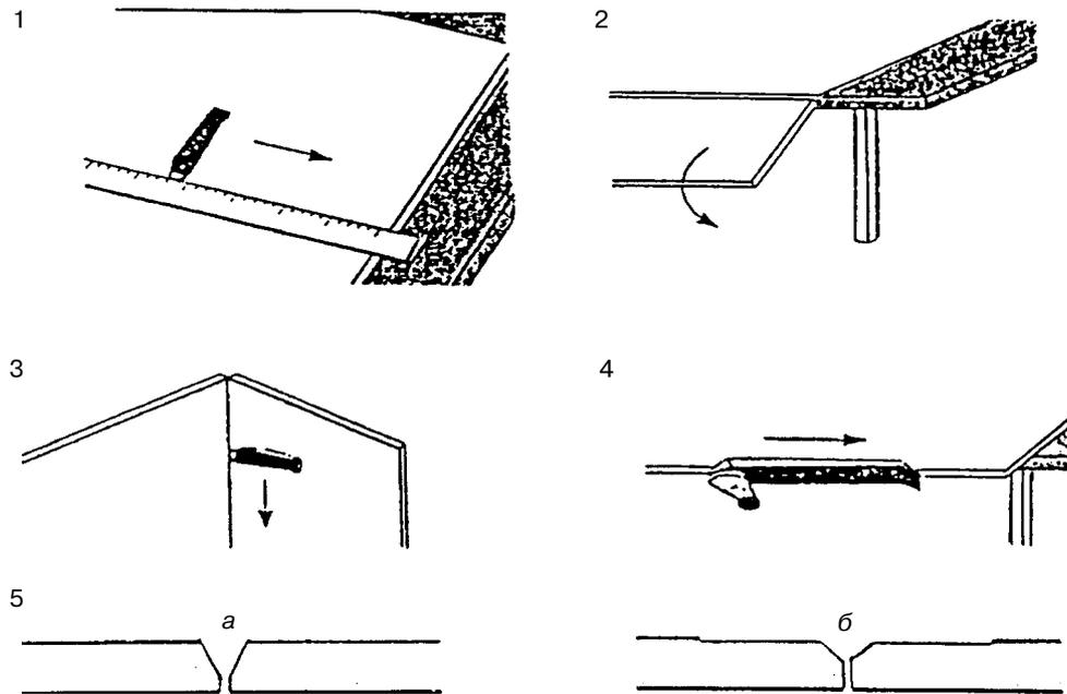
1 — резка; 2 — надлом; 3 — разрезка картона на обратной стороне ГКЛ; 4 — обработка обрезанной кромки рубанком; 5 — подготовка обрезанной кромки под шпаклевку шва с армирующей лентой
