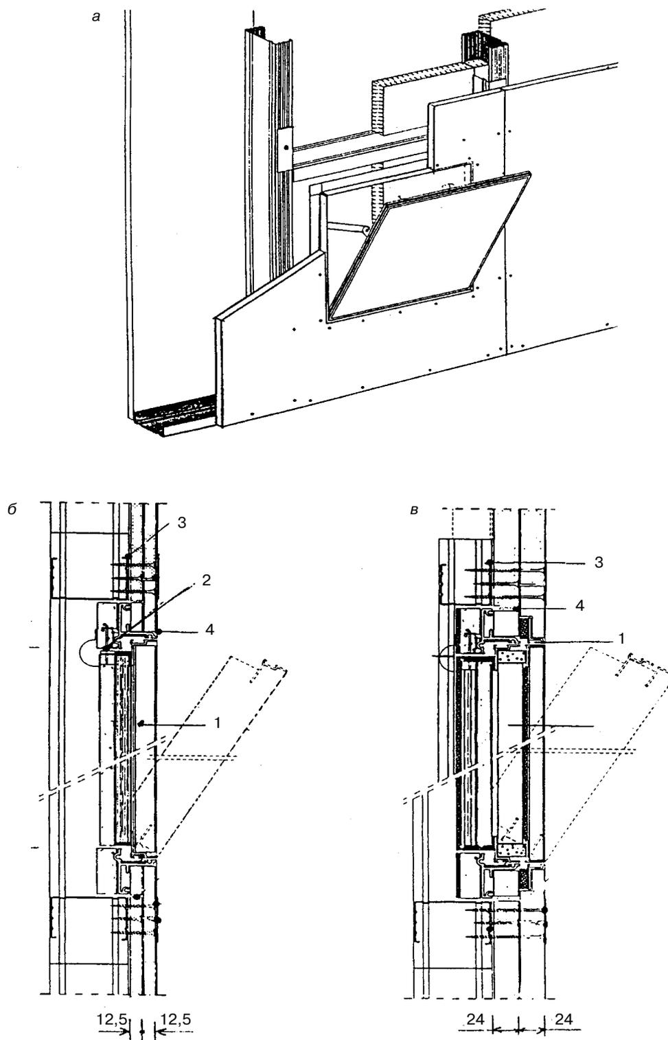
1 — крышка ревизионного клапана; 2 — запор; 3 — металлический профиль каркаса; 4 — рама проема
