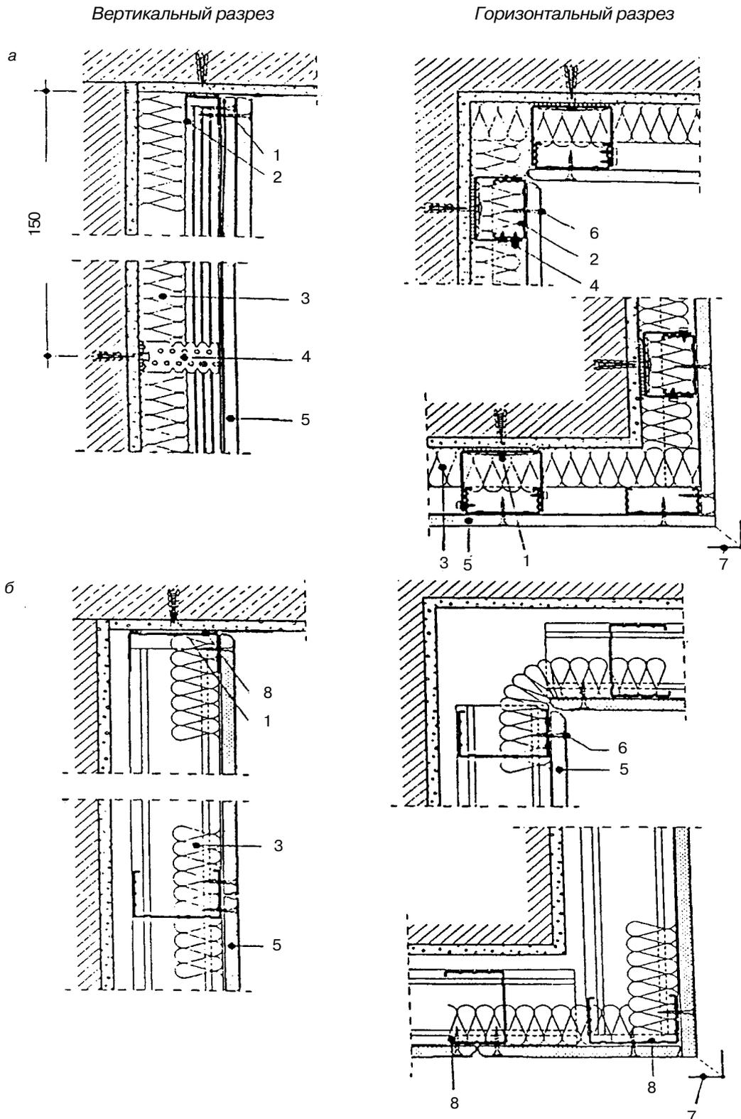
1 — дюбель; 2 — каркас из профилей ПНП и ПП; 3 — минераловатная плита; 4 — прямой подвес; 5 — обшивка ГКЛ; 6 — самонарезающий шуруп; 7 — угловой профиль; 8 — каркас из профилей ПН и ПС
