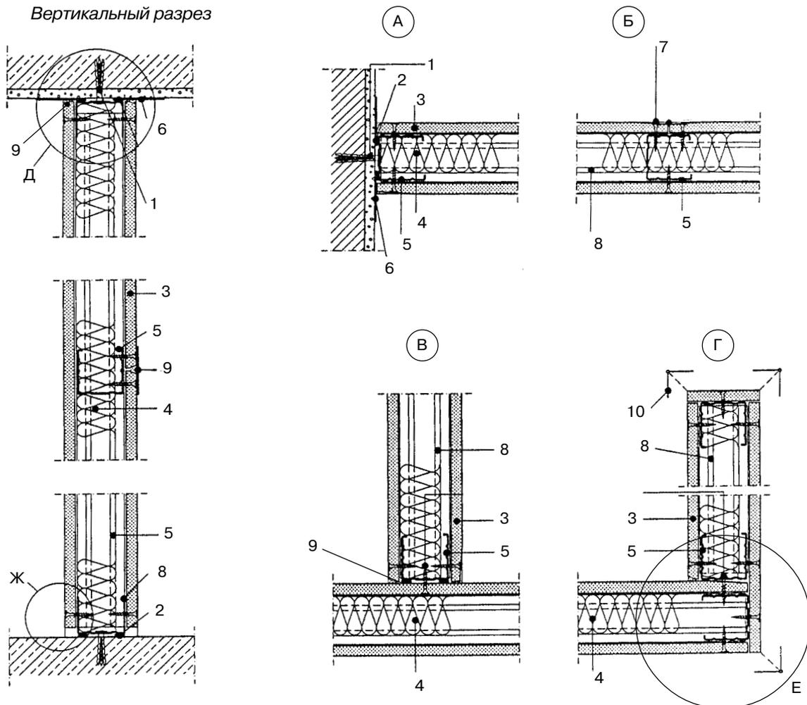
1 — дюбель; 2 — лента уплотнительная (герметик); 3 — обшивка из ГКЛ; 4 — минераловатная плита; 5 — профиль ПС; 6 — лента разделительная; 7 — самонарезающий шуруп; 8 — профиль ПН; 9 — шпаклевка; 10 — профиль ПУ
