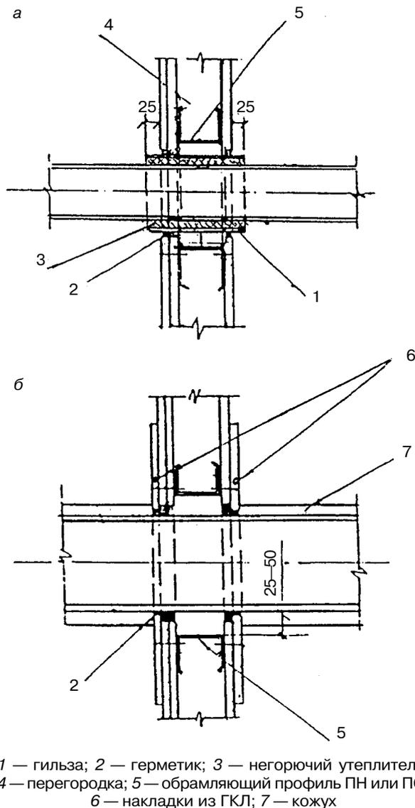
1 — гильза; 2 — герметик; 3 — негорючий утеплитель; 4 — перегородка; 5 — обрамляющий профиль ПН или ПС; 6 — наклейки из ГКЛ; 7 — кожух
