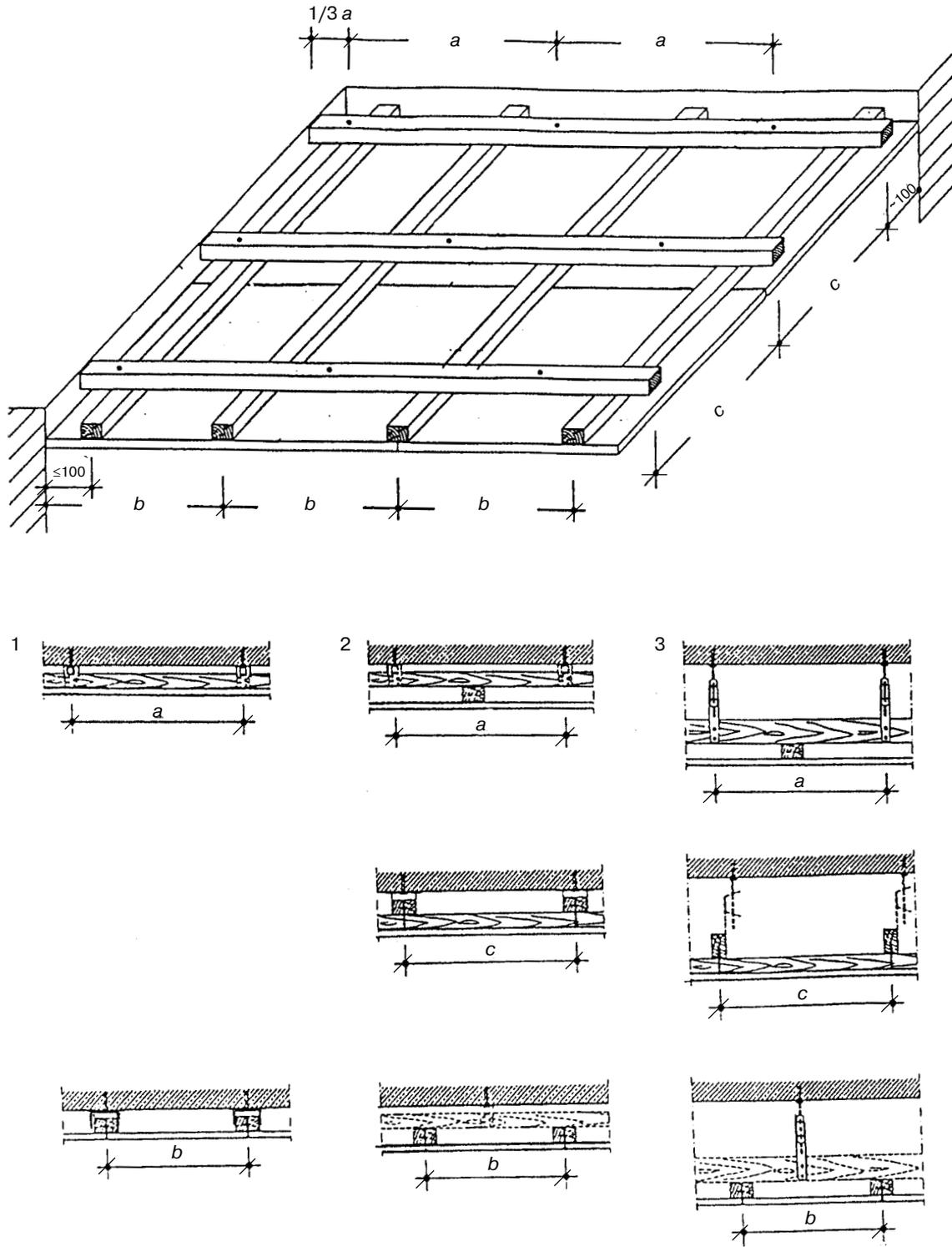
1 — с одноосным каркасом, закрепленным непосредственно к перекрытию или с помощью прямых подвесов с небольшим откосом; 2 — то же, с двухосным каркасом; 3 — с двухосным каркасом на подвесах, со значительным откосом;  $a$  — расстояние между подвесами;  $b$  — расстояние между несущими брусками;  $c$  — расстояние между основными брусками
