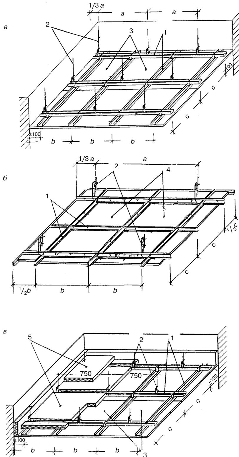
1 — каркас; 2 — подвесы; 3 — обшивка из гипсокартонных листов; 4 — кассеты из гипсокартонных листов; 5 — огнезащитный теплоизоляционный материал;  $a$  — расстояние между подвесами;  $b$  — расстояние между несущими профилями;  $c$  — расстояние между основными профилями
