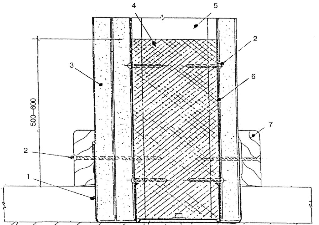
1 — гидроизоляция; 2 — самонарезающий шуруп; 3 — обшивка из ГКЛ; 4 — минераловатная плита; 5 — профиль ПС; 6 — оцинкованный лист,  $\delta = 0,06$  мм; 7 — глинтус
