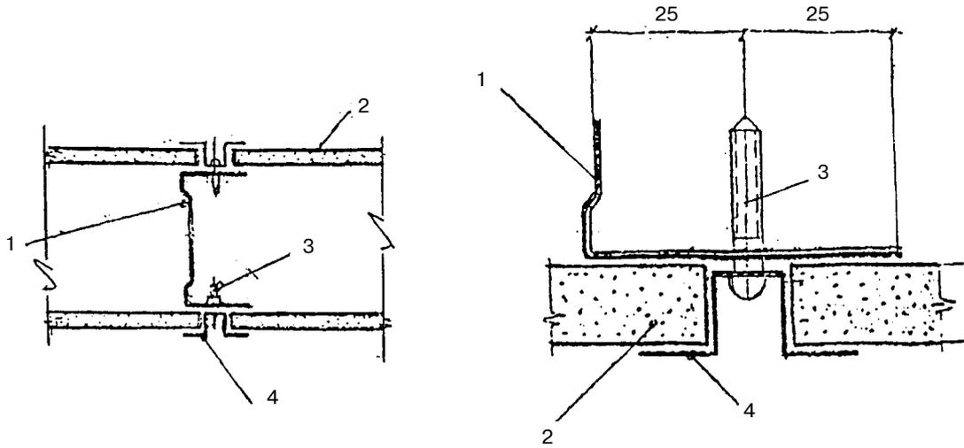
1 — стоечный профиль; 2 — обшивка панелей отделочных гипсокартонных (ПОГ);
