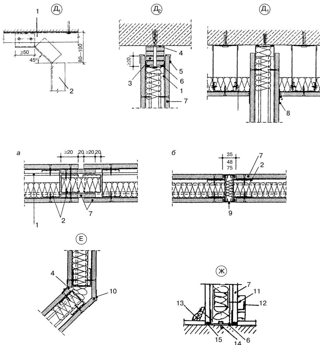
1 — профиль ПН; 2 — профиль ПС; 3 — полосы из ГКЛ; 4 — шпаклевка; 5 — профиль ПТ; 6 — лента уплотнительная (герметик); 7 — обшивка из ГКЛ; 8 — лента разделительная; 9 — деформационный профиль; 10 — разогнутый профиль ПУ; 11 — самонарезающий шуруп; 12 — электротехнический плинтус; 13 — деревянный плинтус; 14 — дюбель; 15 — герметик
